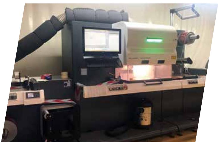
Il nuovo sistema di taglio e mezzo taglio a LASER. Grazie a questo nuovissimo sistema LASER di ultima generazione è possibile fare ogni tipo di Kiss Cut personalizzato, Marcatura Laser con Loghi su commissione e Graphic design per ogni esigenza del cliente.
